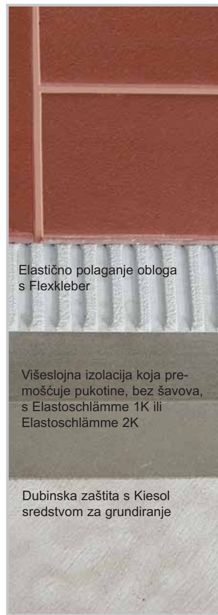
Izgradnja sustava alternativne izolacije zajedno s keramičkim oblogama
